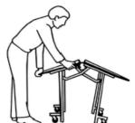
2 Raise lock toward the table top. Lift the table at the center and push down at edge from center. Levante el brazo de fijación hacia la tapa de la mesa. Levante el centro de la mesa y empuje hacia abajo sobre el centro del borde.
